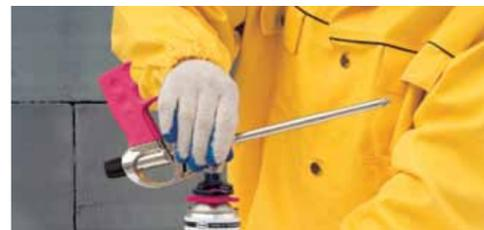
Удалить защитный колпачек и, установив баллон на поверхность, прикрутить монтажный пистолет.
