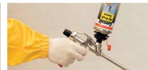
Перед большим перерывом в работе установить баллон очистителя на пистолет и промыть его, нажимая на спуск пистолета.
