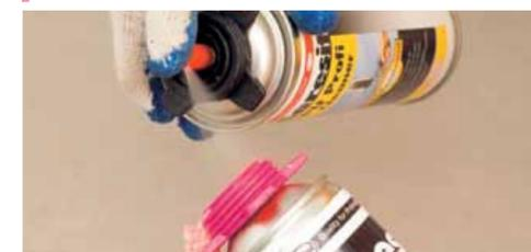
Если открытый баллон будет снова использоваться, очистите гнездо клапана струей промывочной жидкости (например, Ceresit PU Cleaner).
